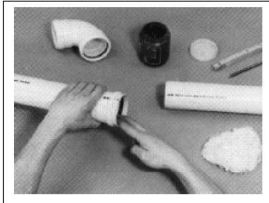
Deverá ser aplicada pasta lubrificante no anel e na ponta do tubo. Não será admitido o uso de óleo ou graxa, que poderão atacar o anel de borracha.
